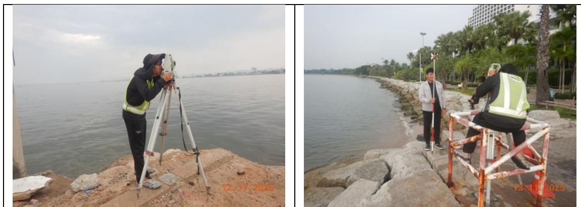
รูปที่ 3.4.7-4 : เครื่องวัดมุม Total Station ยี่ห้อ SATLAB model Satlab: SLT2
