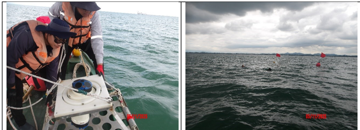
รูปที่ 3.4.7-23 : การวัดทิศทางและความเร็วกระแสน้ำ ด้วย ADCP (Acoustic Doppler Current Profiler)
