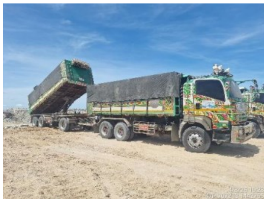
รูปที่ 2-8 : การปิดคลุมขณะเทกอง
