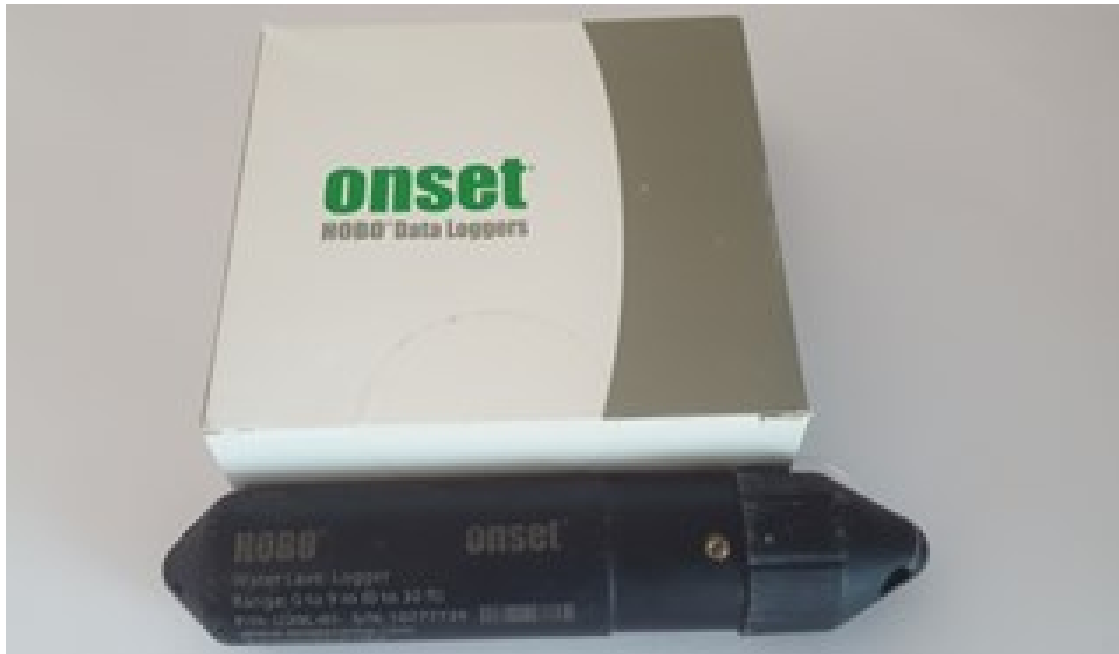
รูปที่ 3.4.7-30 : เครื่องมือตรวจวัดระดับน้ำแบบอัตโนมัติ Water Level Logger ยี่ห้อ Onset รุ่น HOBO®
