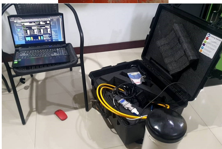
รูปที่ 3.4.7-22 : เครื่องวัดกระแสน้ำตามความลึกด้วยคลื่นเสียง Acoustic Doppler current profiler (ADCP) รุ่น RDI Sentinel V50 Self-contained ความถี่ 500 kHz
