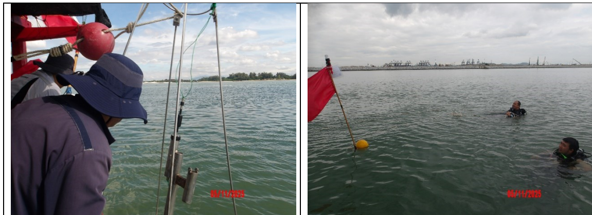
รูปที่ 3.4.7-25 : การติดตั้งอุปกรณ์ตรวจวัดทิศทางและความเร็วกระแสน้ำด้วย EM บริเวณปากคลองบางละมุง
