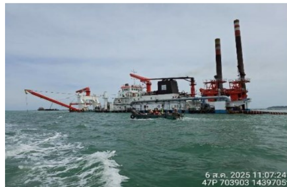
รูปที่ 2-38 : เรือชุดแบบ Cutter Suction Dredger
