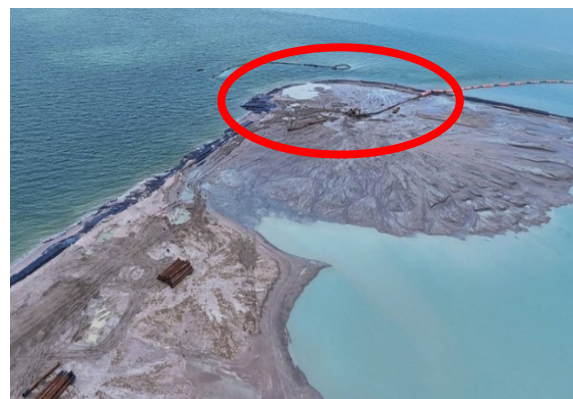
รูปที่ 2-41 : การถมพื้นที่ขณะที่พื้นที่ยังไม่เป็นพื้นที่ปิดล้อม
