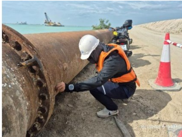
รูปที่ 2-39 : การตรวจสอบท่อลำเลียง
